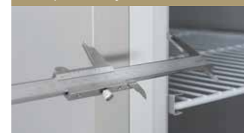
▲ Spessore isolamento = 70mm Insulation thickness = 70mm
